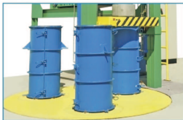
∴ MODELO TBG COM BASE GIRATÓRIA (03 posições indexáveis).
